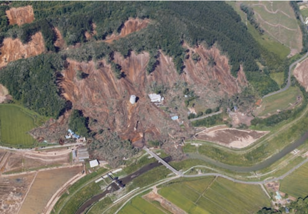
昨年8月に配水を開始したばかりの富里浄水場が土砂崩れにより稼働停止に（写真：国土交通省北海道開発局提供）
