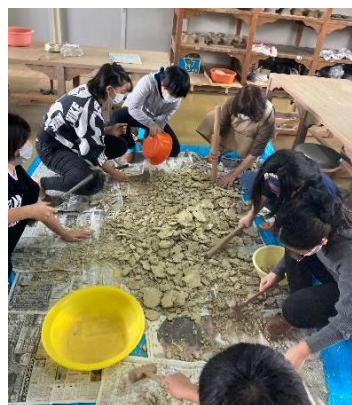
粘土の不純物の除去作業
