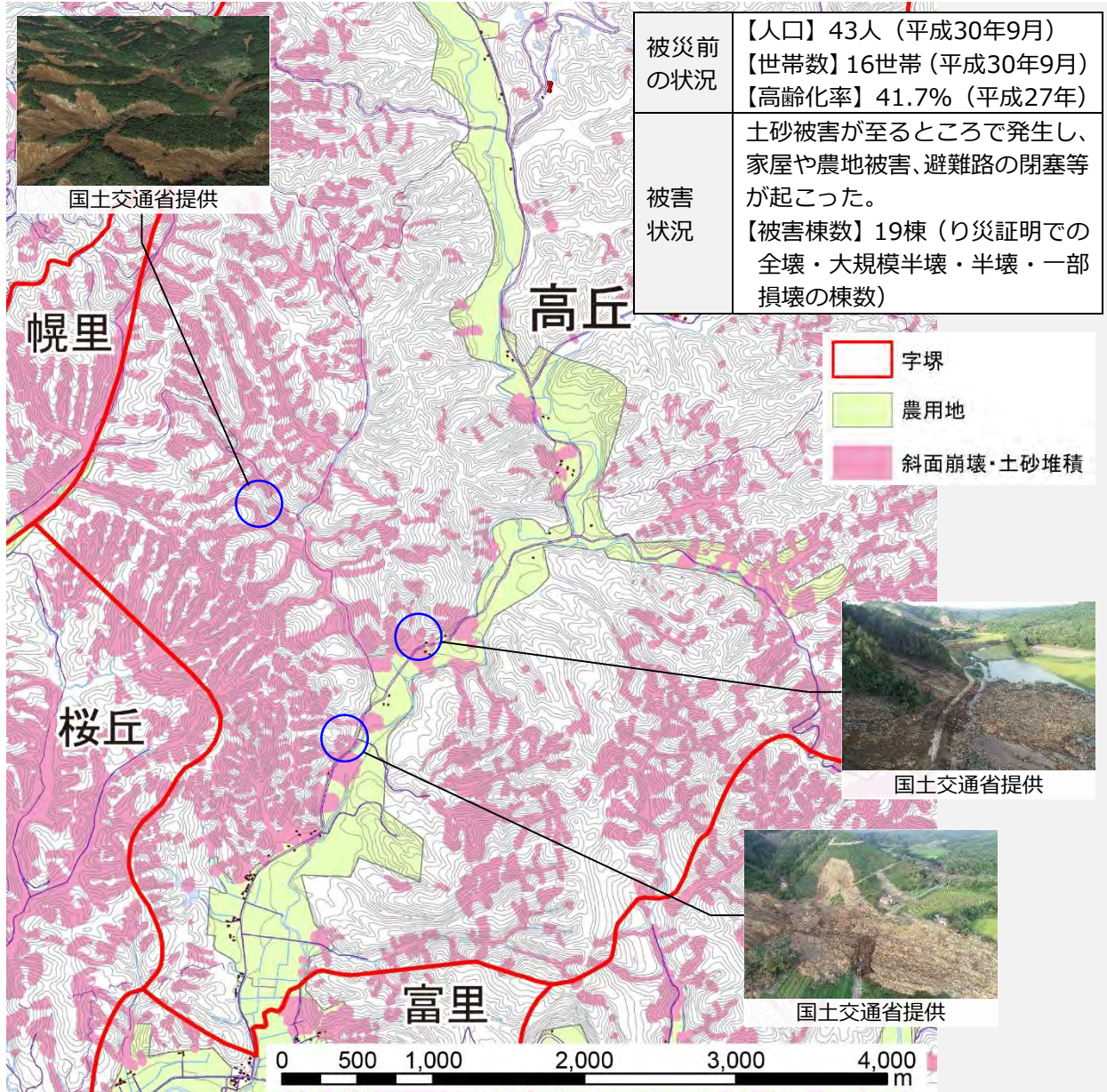
図表4-13 高丘地区の被害状況等
