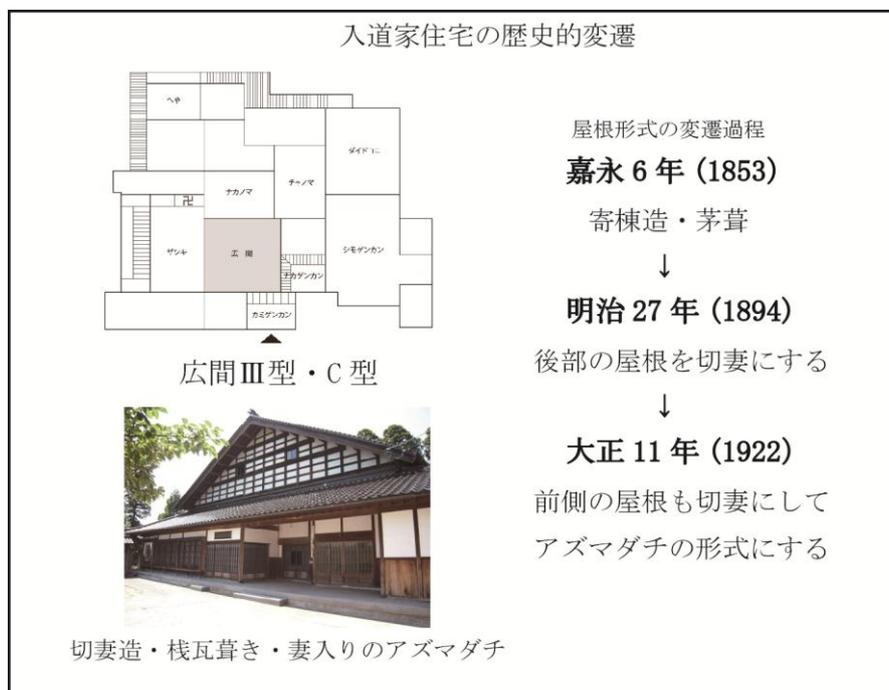
図4-(3)-1 入道家住宅の枠の内構法の歴史の変遷
