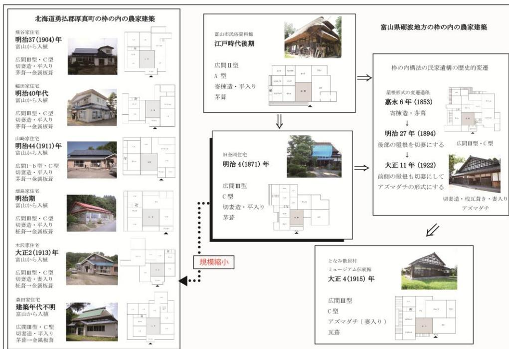
図5-1 厚真町と砺波地方における枠の内構法の歴史的変遷
