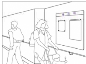
主要動線上、かつ、通行の支障 にならない位置に掲示板を設置
