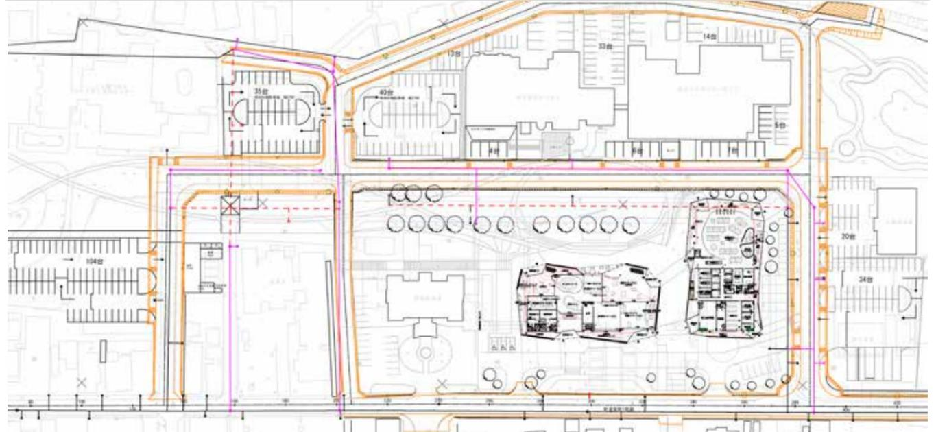
新設汚水管延長 L=約540m
