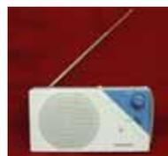
厚真町では、皆様のご家庭に災害時などに情報を提供する「防災行政無線戸別受信機」を設置しています。この受信機は停電になった場合、自動的に電源が乾電池に切り替わり、受信機を機能させます。1年に1回は乾電池を交換し、停電時に備えてください。受信機が設置されていない家庭や設置されていても不具合がある場合は、役場総務課(☎27-2321内線215)までお問い合わせください。
