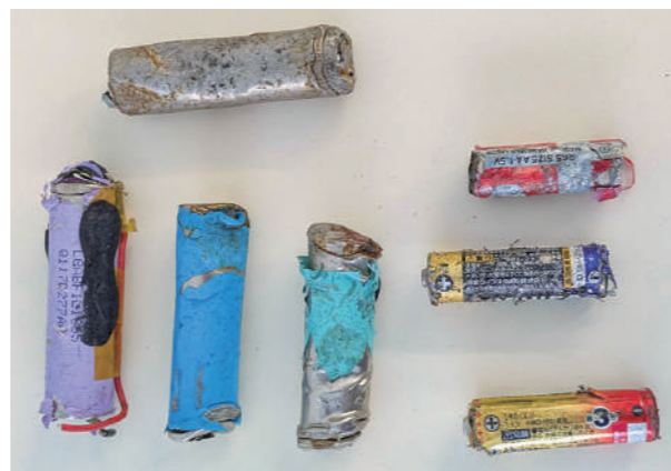
火災発生時に発見された乾電池とリチウムイオン電池
